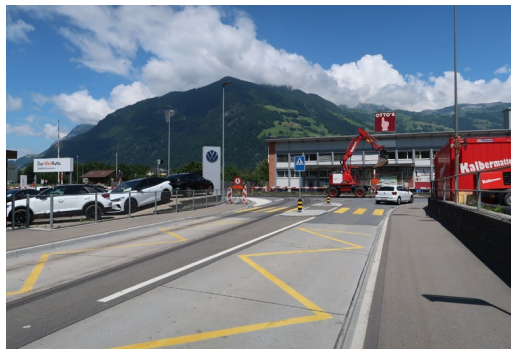
Abbildung 18: Beispiel einer nicht überholbaren Fahrbahnhaltestelle (Aufnahme in Schattdorf)
